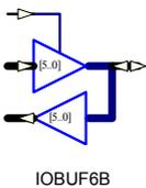
IOBUF, IOBUF 2, IOBUF 3, IOBUF4, IOBUF5, IOBUF6, IOBUF7, IOBUF8, IOBUF9, IOBUF10, IOBUF12, IOBUF16, IOBUF32 are respectively 1-, 2-, 3-, 4-, 5-, 6-, 7-, 8-, 9-, 10-, 12-, 16-, 32-bit input/output buffers.
